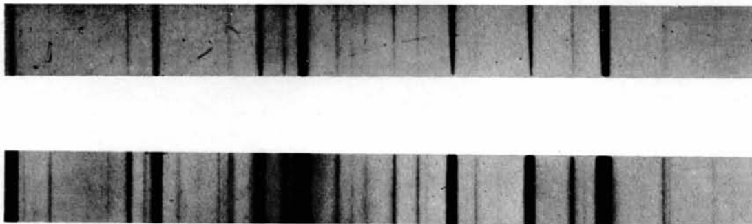
Fig. 1. Radiogrammes par réflexion sur le plan de clivage d'un monocrystal de mica. Tension 25 kV. Temps d'exposition (a) 25, (b) 100 mA. min. Grandissement linéaire \sim 1,5 .
